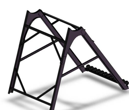
Figura: Schema de montare a cadrului unei instalații cu 20 de tuburi
